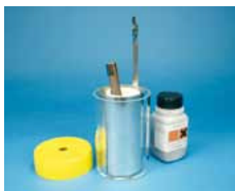
18370 Pila Leclanché Consta de un recipiente de vidrio con tapa conteniendo un electrodo cilíndrico de zinc y otro de barra de carbón separados por un vaso poroso cerámico. Voltaje generado 1,5 V. Reactivo a usar \text{NH}_4\text{Cl} al 20%. Incluye 250g de óxido de manganeso IV. Altura del recipiente de vidrio 150 mm.
