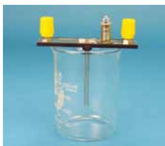
18380 Aparato de conductividad Para estudiar la conductividad de soluciones electrolíticas. Se compone de una placa con dos terminales metálicos de Ø2x75 mm, dos bornes de 4mm para aplicar tensión y una bombilla que lucirá en función de la conductividad de la muestra. Vaso no incluido.
