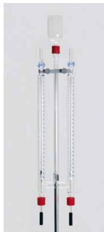
18395 Voltámetro de Hoffmann Para realizar la electrolisis del agua y medir la cantidad de hidrógeno y oxígeno generados. Se compone de dos tubos colectores de gas graduados (0 a 50 ml en 0,2 ml) con llaves de paso, conectados por un tubo de vidrio y un depósito de expansión. Conectores inferiores GL-18 para montar electrodos. Se incluyen dos electrodos de C (ref. 18397), dos electrodos de Pt (ref. 18398), base con varilla y pinzas de fijación. Los electrodos tienen incorporados bornes de 4 mm para alimentarlos eléctricamente. Longitud del vidrio 510mm, ancho 100mm. Adicionalmente se requiere fuente de alimentación a 12 VCC, p. ej. ref. 16215.
