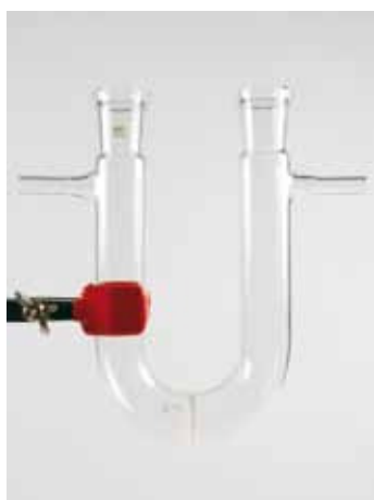
18377 Tubo en U con puente salino Para experimentos de electrolisis en los que se usan dos electrolitos. Tubo en U de vidrio con puente salino central y olivas laterales. Altura total 150 mm.
