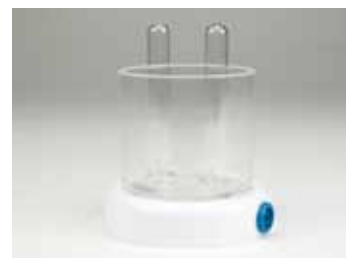
18386 Voltámetro estudiante Pequeño voltámetro consistente en un recipiente de material acrílico resistente a ácidos, dos electrodos de platino y dos tubos de ensayo invertidos para recolectar los gases generados. Dispone de dos bornes de 4 mm para la alimentación eléctrica. Diámetro interior 61 mm, altura interior 56 mm. Peso 68 g. Para alimentarlo se necesita adicionalmente una fuente de alimentación entre 0 y 5 VCC, por ejem. ref. 16215.
