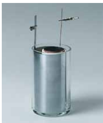
18365 Pila Daniell Consta de un recipiente de vidrio conteniendo dos electrodos cilíndricos de zinc y cobre separados por un vaso poroso cerámico. Voltaje generado 1,1 V. Reactivos a usar: \text{CuSO}_4 al 10% y \text{ZnSO}_4 al 10%. Altura del recipiente de vidrio 150 mm.
