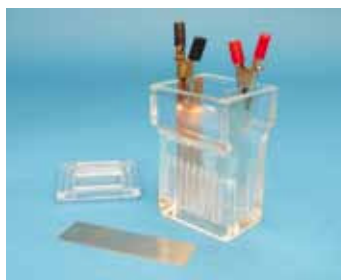
18360 Pila de Volta Consta de una cubeta de vidrio con ranuras, un electrodo de Cu, dos de Zn y dos pinzas de cocodrilo con toma de 4mm. Voltaje generado 0,9-1,1 V. Reactivo a usar: ácido sulfúrico al 10%. Altura de la cubeta 85 mm.
